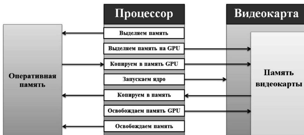
Рис. 2. Схема работы программы на CUDA
