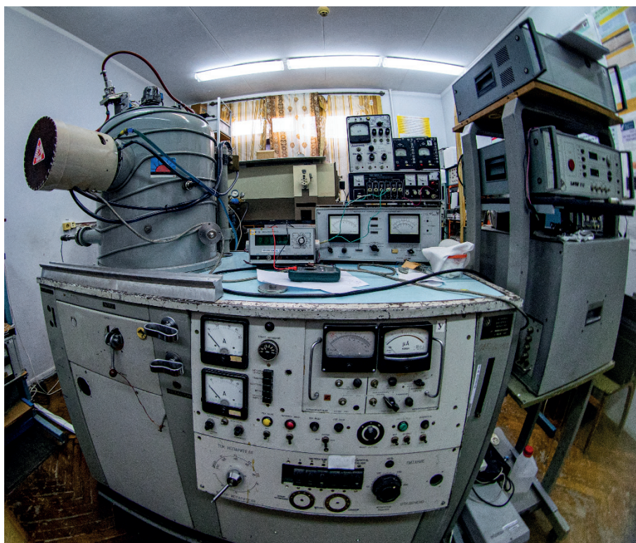
Рис. 1. Внешний вид модернизированной установки реактивного магнетронного распыления УВН-2М
