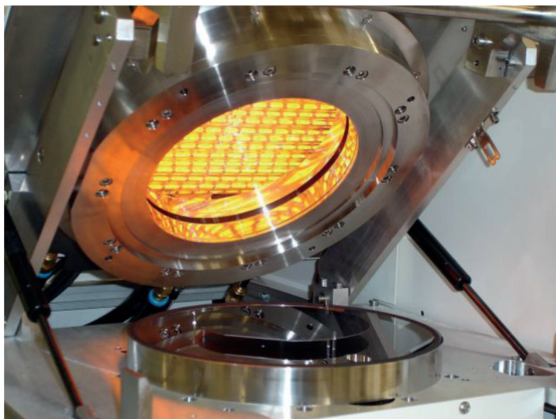
Рис. 9. Установка быстрого термического отжига AS-One 100 HT
